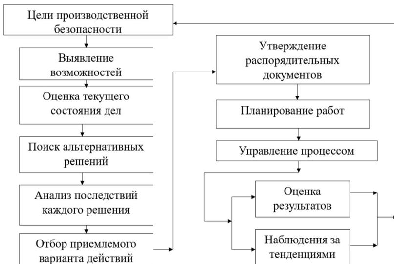
**Рис. 1.** Алгоритм процесса управления производственной безопасностью на авиапредприятии
