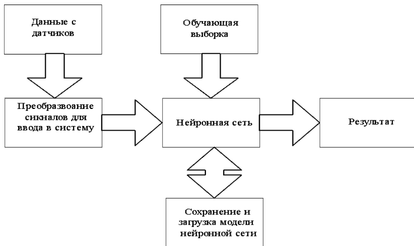
Рис. 2. Архитектура виртуального анализатора синтеза МТБЭ
