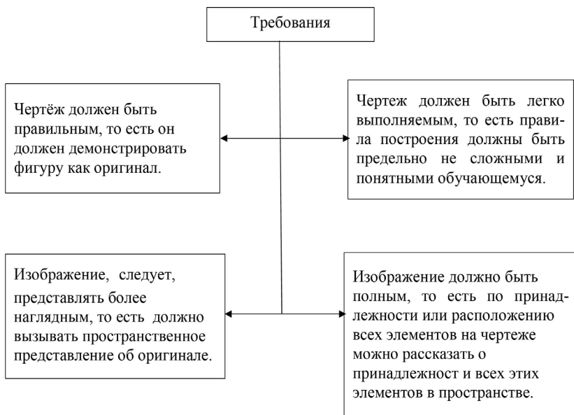
Рис. 2. Требования при построении геометрических фигур
