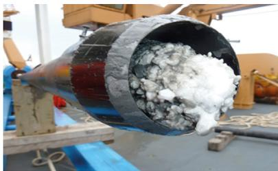
Рис. 1. Гидратная пробка
